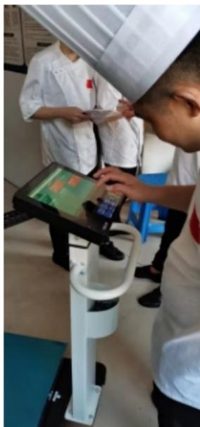
当物体放在秤盘上时，压力施加给传感器，该传感器发生弹性形变，从而使阻抗发生变化，同时使用激励电压发生变化，输出一个变化的模拟信号。该信号经放大电路放大输出到模数转换器。转换成便于处理的数字信号输出到CPU运算控制，CPU根据键盘命令以及程序将这种结果输出到显示器。直至显示这种结果。使用功能：电子秤采用现代传感器技术、电子技术和计算机技术一体化的电子称量装置，才能满足并解决现实生活中提出的“快速、准确、连续、自动”称量要求，同时有效地消除人为误差，使之更符合法制计量管理和工业生产过程控制的应用要求。餐饮店智能电子秤-推荐上海博菜！福建智能一站式电子秤哪里好
